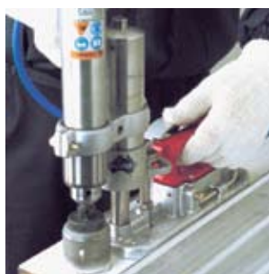
Tillspänningen aktiveras med vipp-greppet.
