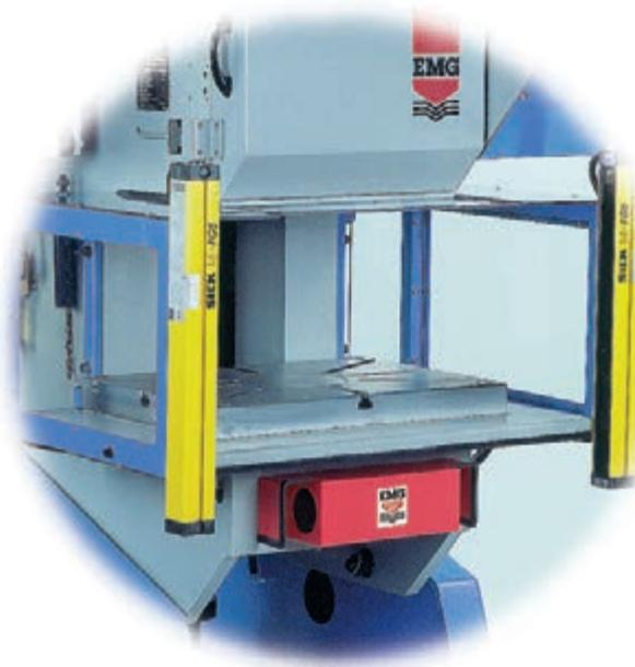
Les barrières immatérielles permettent la protection frontale de la zone dangereuse et commandent le démarrage du cycle après un ou deux passages dans le faisceau. Supprimant l'utilisation de la commande bimanuelle, cet équipement assure une sécurité maximale tout en améliorant la productivité de la presse. Il est également toujours possible de travailler en protection simple en utilisant la pédale pour déclencher le cycle.
