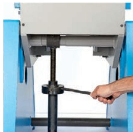
*Réglage de l'inclinaison (hydraulique sur 45 et 80t)*
