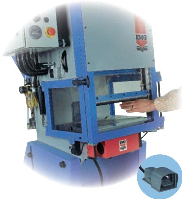
L'écran vertical automatique assure la protection frontale et latérale de l'opérateur et des tiers. Un appui maintenu sur la pédale ordonne d'abord la descente de l'écran jusqu'à son point mort bas, le départ du cycle n'étant autorisé que si le bord sensible ne rencontre aucun obstacle.
