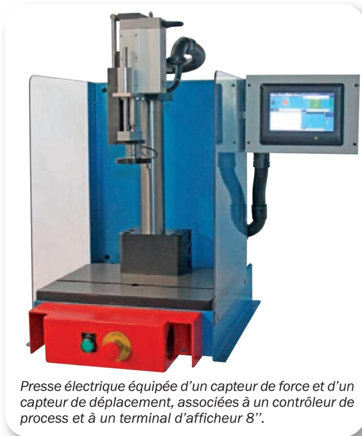
Presse électrique équipée d'un capteur de force et d'un capteur de déplacement, associées à un contrôleur de process et à un terminal d'afficheur 8".
